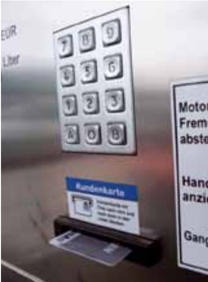
Abrechnung per Chipkarte: Die Treibgastankstelle von PBS besitzt ein integriertes Datenerfassungssystem.
